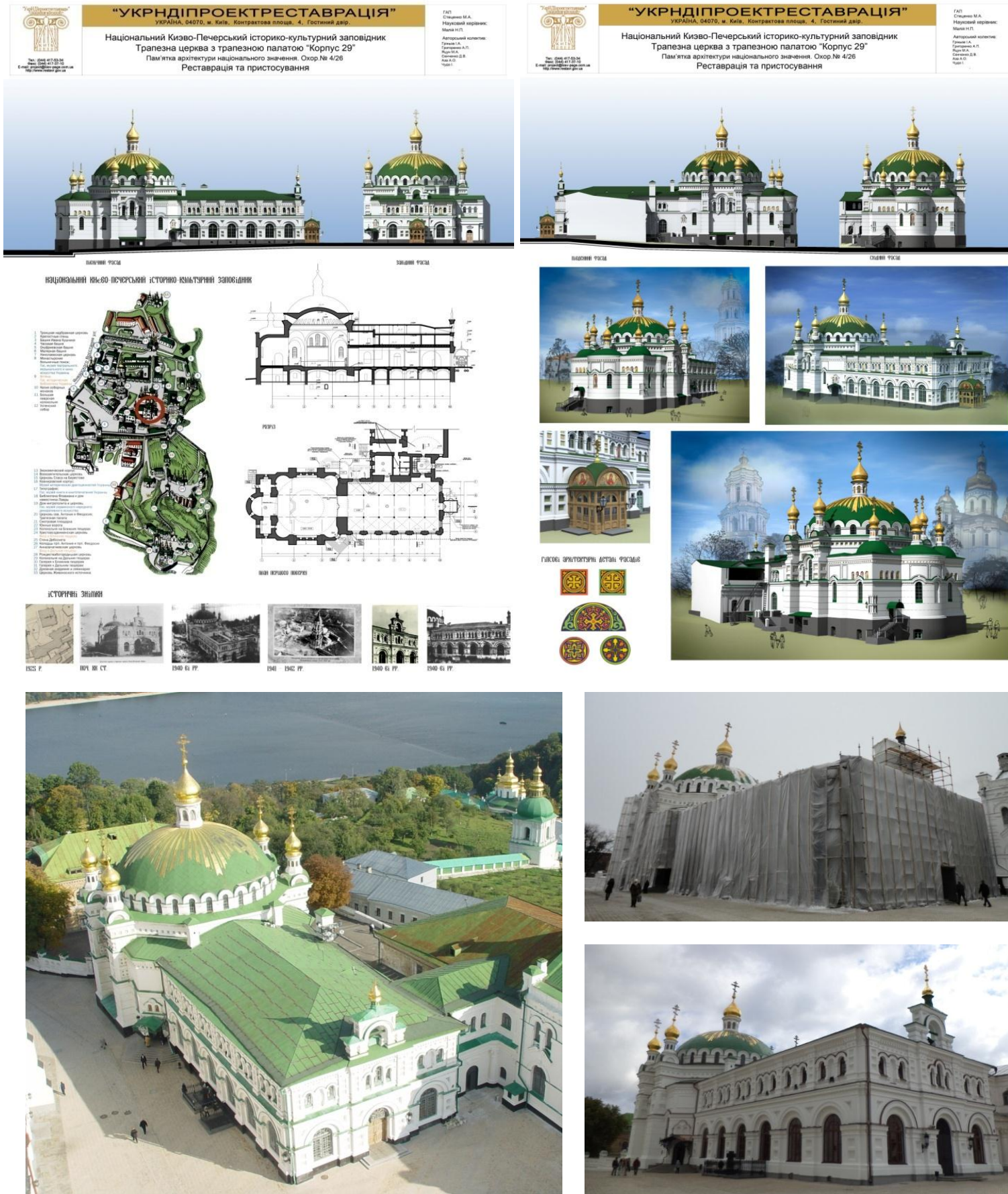
Комплексні реставраційні роботи з реставрацією та відтворенням втраченого живопису в інтер'єрі Трапезної Києво-Печерської лаври, Київ (частково реалізовано);
